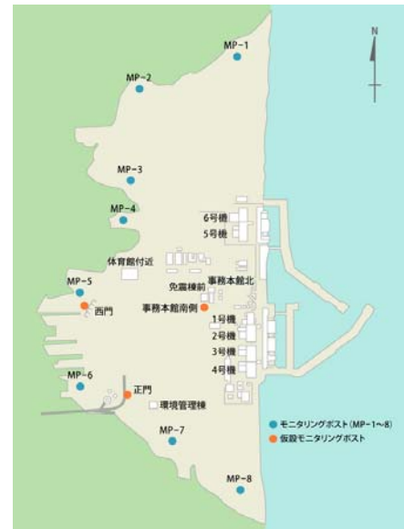
モニタリングポストの位置 (仮設は震災後に設置)
