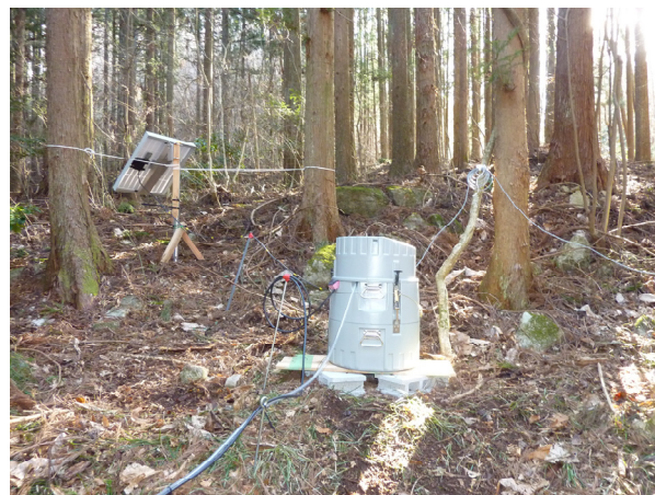
写真2 自動採水装置
